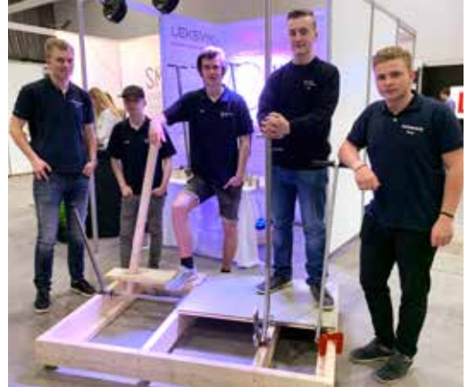
AutoSteel UB fra Leksvik videregående skole hadde laget et verktøy, en jekk, for å gjøre gulvlegging enklere. Jekken klemmer seg fast på bjelkene i gulvet og presser sammen platene. Produktet er utarbeidet sammen med en annen ungdomsbedrift som går Byggfag VG2 ved skolen.
